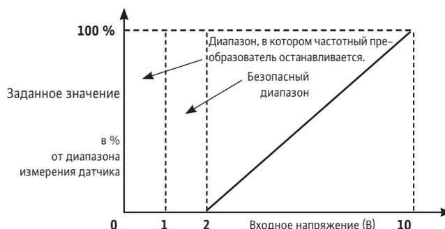
**IN2: Вход внешнего управления частотой в режиме «Регулирование частоты вращения»**
